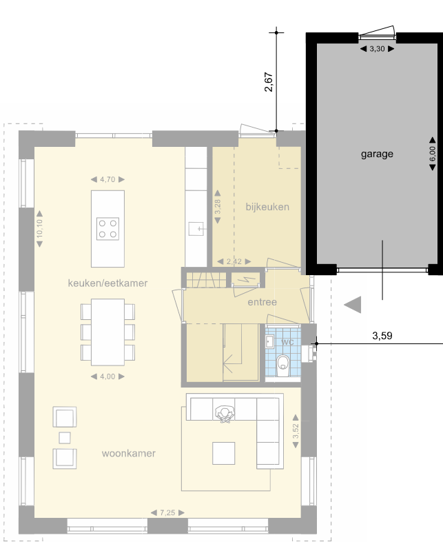
type 3 - inwendig 3,30 x 6,00 meter
