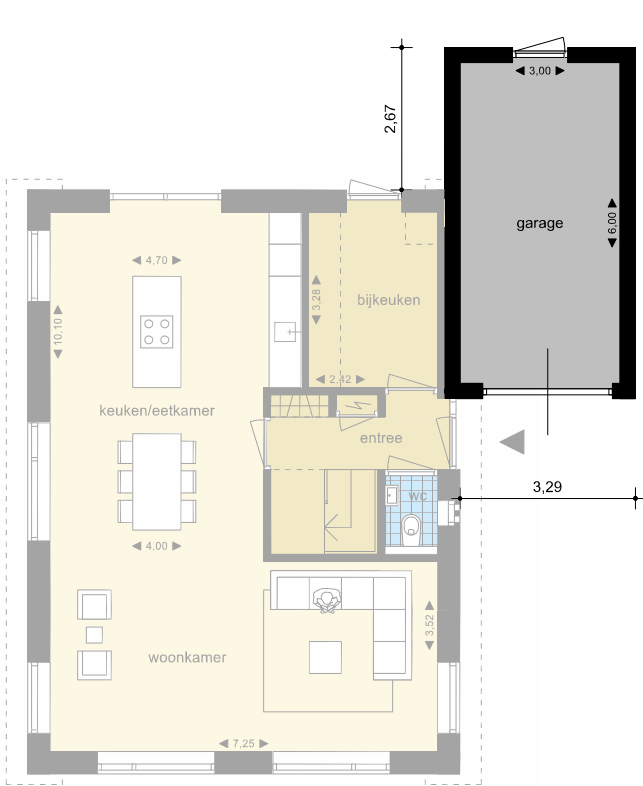
type 1 - inwendig 3,00 x 6,00 meter
